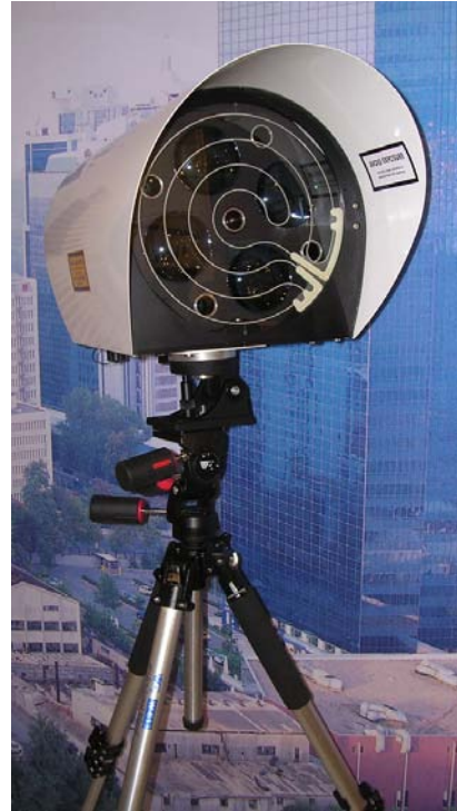
Teleskopa benzeyen bu alet, lazer ışınları yardımıyla yüksek hızlı veri iletişimi kurabilen bir Free Space Optics cihazı.
