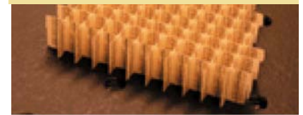
Şekil 3: UCSD’deki grubun negatif kırılmayı gözlemlediği metamalzeme. Burada kesik halkalı rezonatörler ve onların arkasına yerleştirilmiş bakır teller, malzemenin mikrodalgalara karşı negatif kırılma indisi göstermesini sağlıyor. Burada rezonatörler ve teller fibreglas bir devre kartı üzerine basılmış.
