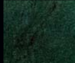
10. Gemlik Dişabaz 259 Bursa / Genlik Yaklaşık 180-230 milyon yıl yaşlı Dişabaz Döşeme, iç ve dış kaplama Fayans ve plaka elde edilir
