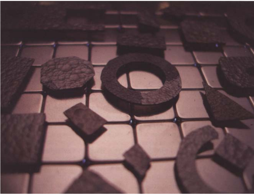
Çeşitli şekillerde kesilmiş pirolitik grafit parçalar ilginç bir şekilde havada duruyor. Bu resimdeki düzende, kalıcı bir mıknatısın üzerinde asılı 120 cisim var. Aktif geribildirimli kullanarak aynı cisimleri havaya kaldıracak ve dışardan verilen güçle çalışacak bir aygıt, tasarım ve üretim açısından önemli bir mühendislik girişimi olurdu. Buradaki basit, pasif diamanyetik yükselme sistemise bu işi daha kolay yapar.
