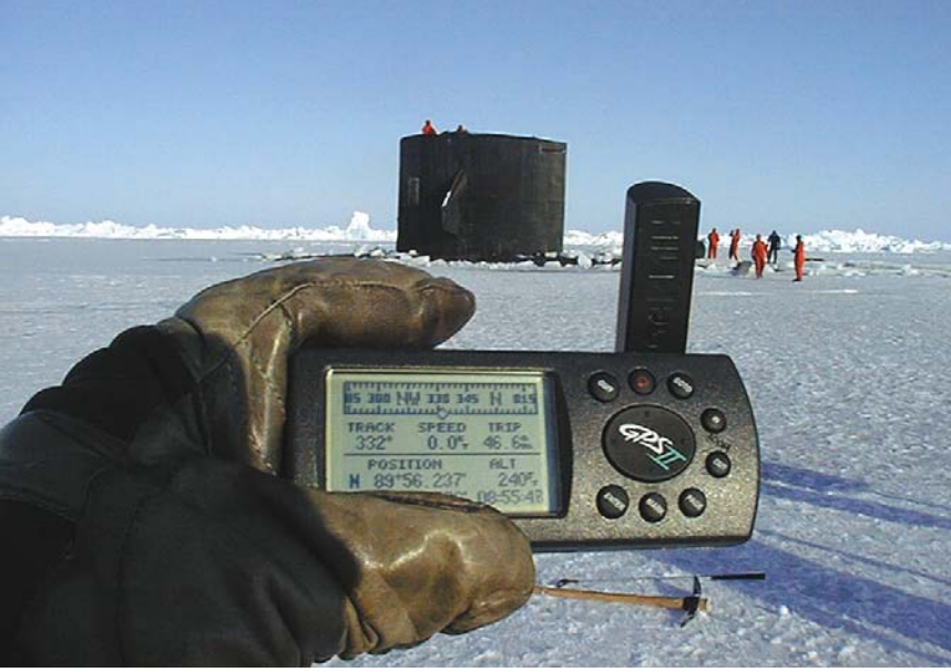
GPS alıcısının temel işlevleri konum belirlemek olsa da, en basit alıcılar bile, konumdaki değişime bakarak hareket eden bir alıcının hızını, katettiği uzaklığı ve gittiği yönü kolayca hesaplayabilirler.
